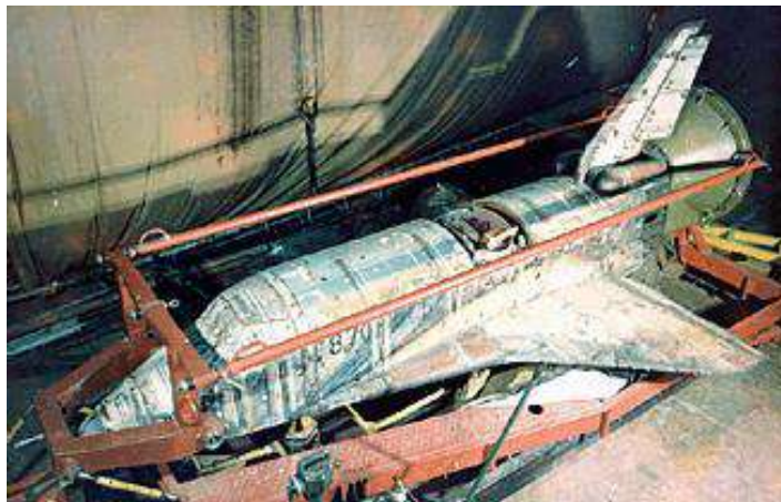
«Бор-5» в монтажно-испытательном корпусе
