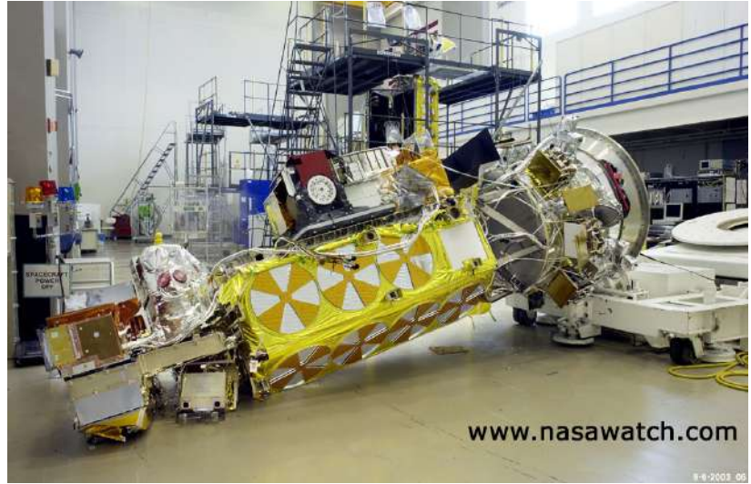
Рисунок 4 – Ошибочные действия персонала космического центра Lockheed Martin ( a ), приведшие к непреднамеренному результату – падению метеорологического спутника NOAA-N-Prime ( б ) [20]
