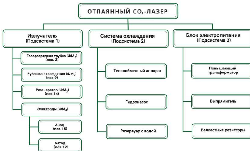
Рисунок 2 – Иерархическая схема отпаянного CO 2 -лазера
