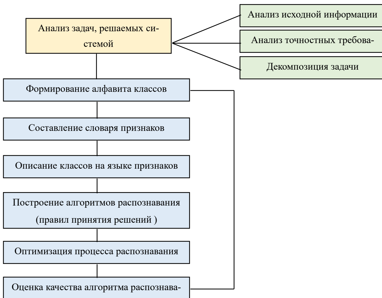
Рисунок 2 – Общая схема построения системы распознавания объектов
