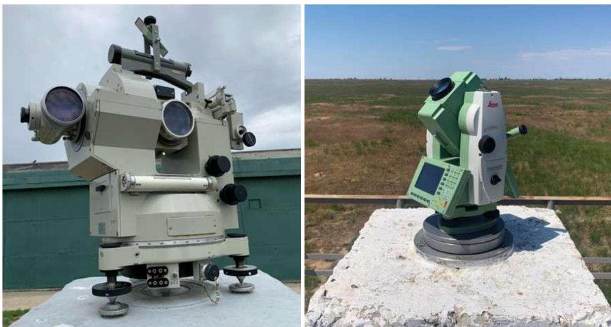
Рисунок 1 – Астрономический универсал (АУ-01) и оптико-электронный тахеометр Leica TCR 1201+ R1000
