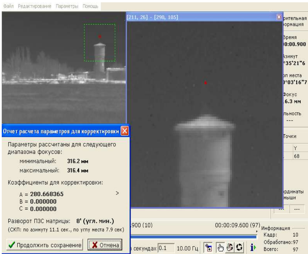
Рисунок 6 – Уточнённые разворот матрицы и фокусное расстояние после корректировки местоположения ХТ
