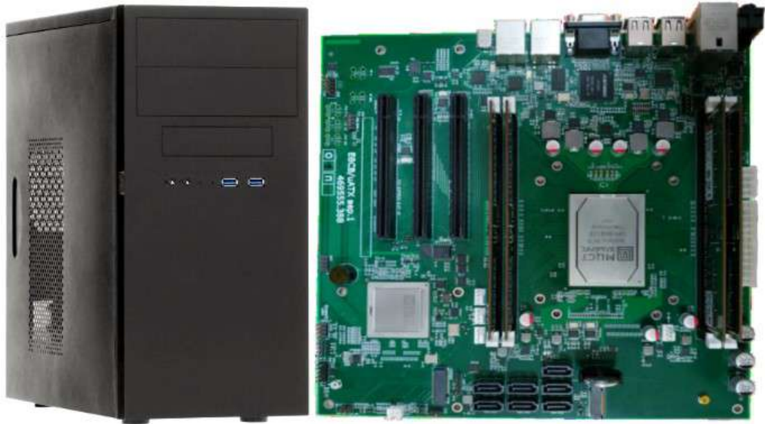
Рисунок 2 – Рабочая станция «1Э8СВ» на базе микропроцессора «Эльбрус-8СВ»
