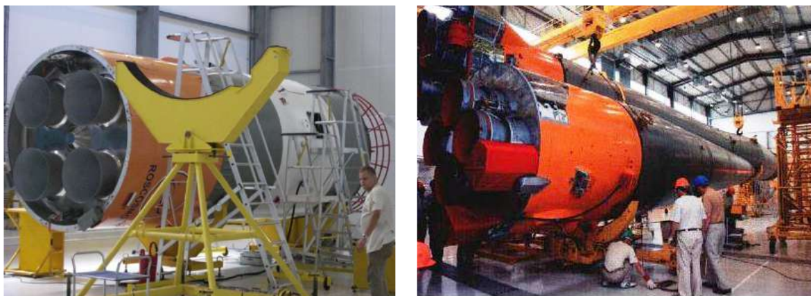
Рисунок 1 – Примеры подготовки ( а ) и пристыковки ( б ) боковых блоков [9]
