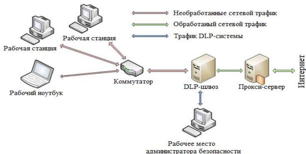
Рисунок 1 – Функциональная схема шлюзового решения в режиме блокировки
