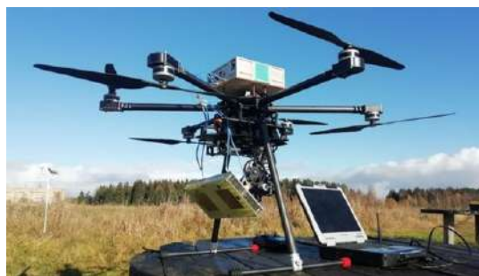
Рисунок 9. – Размещение малогабаритных средств радиолокации на БПЛА квадрокоптерного типа
