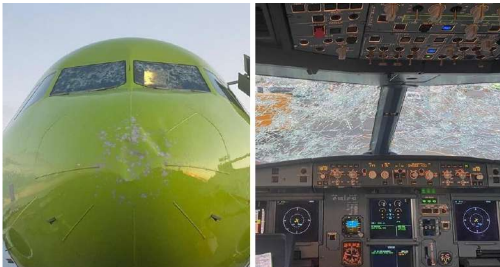
Рисунок 1. – Повреждение носового обтекателя ВС и растрескивание внешнего слоя лобовых стекол пилотов самолета А-320
