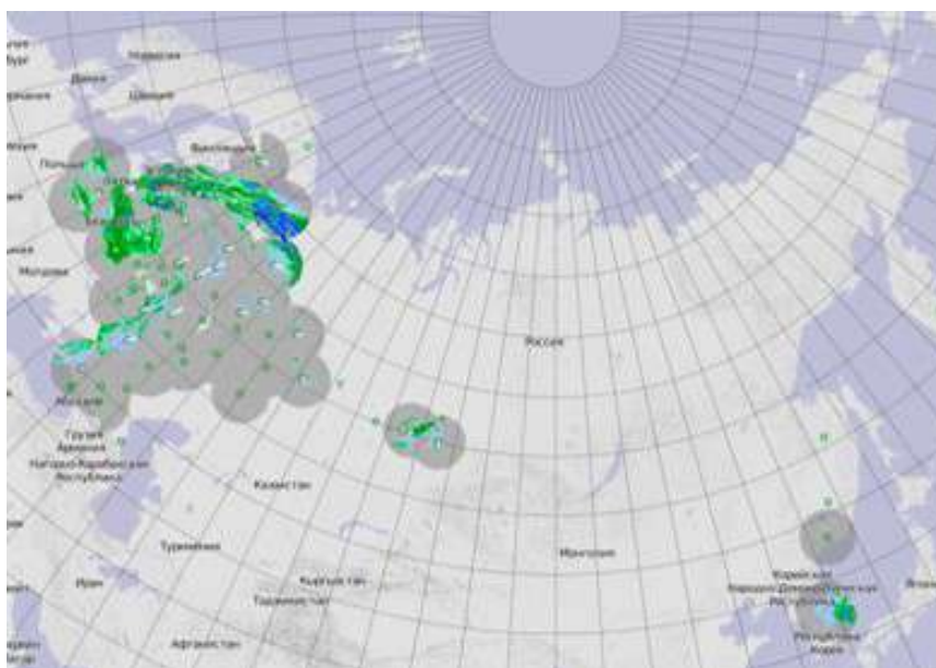
Рисунок 2. – Карта размещения функционировавших ДМРЛ по состоянию на апрель 2024 г. Синими кругами обозначены зоны обзоров ДМРЛ иностранного производства; зеленым – зоны обзоров ДМРЛ-С, проходящих метеoadаптацию [1].
