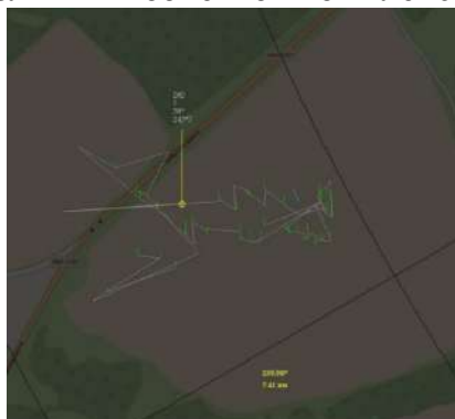
Рисунок 12. – Сопровождение БЛА DJI Phantom 4 (7,5 км)
