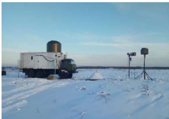
Рисунок 10. – Комплекс РЛК-МЦ в развернутом состоянии с вынесенными средствами РТР и РЭП
