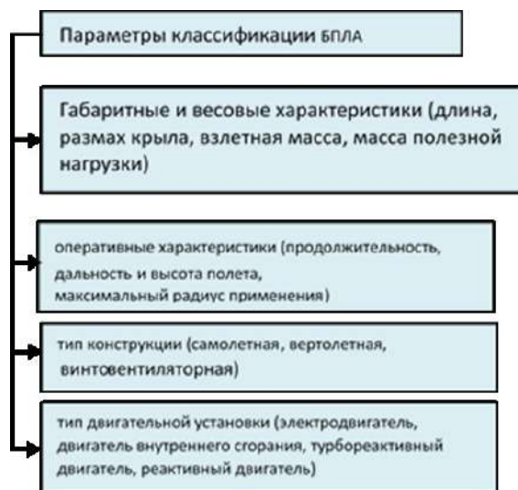
Рисунок 2. – Параметры классификации БПЛА
