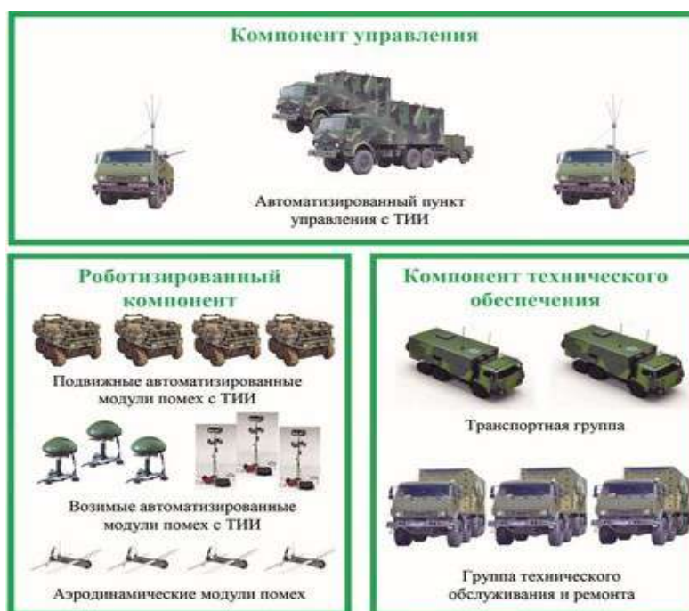
Рисунок 3. – Вариант перспективной архитектуры подразделения РЭБ
