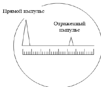
Рисунок 6 – Форма отметок прямого и отраженного импульсов на экране индикатора
