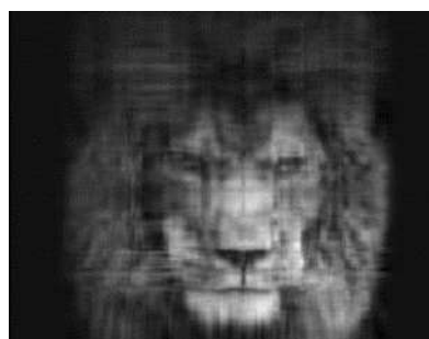
Рисунок 4. – SVD-разложение изображения с 10 главными компонентами
