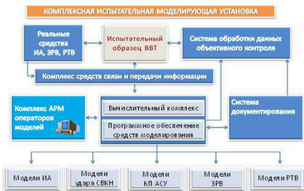
Рис. 2. Схема проведения полунатурного эксперимента с помощью КИМУ
