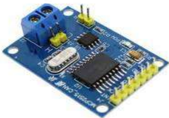
Рис. 1. Типовой CAN контроллер, обеспечивающий подключение к сети по протоколу CAN
